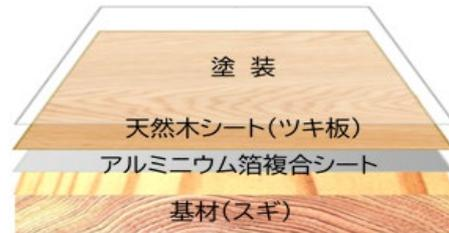
Fig. 1 アルファティンバーの断面構成
