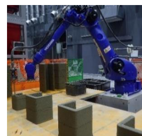
Photo 4 外殻製造状況 Outer Shell Manufacturing
