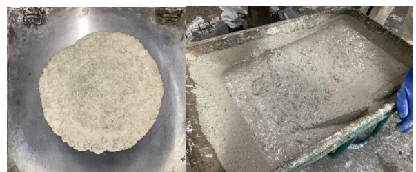
Photo 1 材料分離抵抗性の状況 Material Segregation Status
