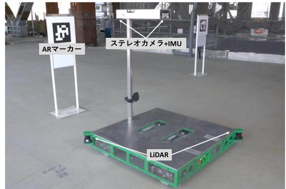
Fig. 5 複数台協調型搬送システムの AGV とマーカー
