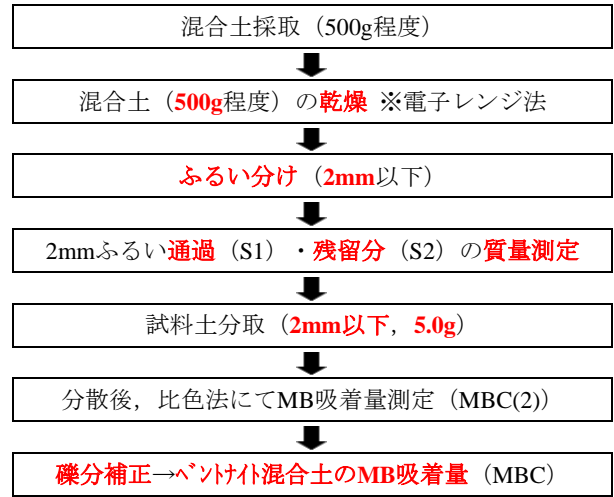
Fig. 13 礫分補正によるMB吸着量測定フロー Methylene Blue Adsorption Amount Measurement Flow by Gravel Correction
