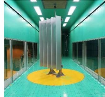
Photo 1 風騒音の風洞実験の実施例
