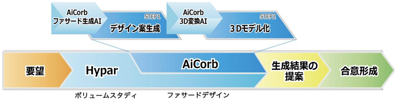
Fig. 1 AiCorbを取り入れた設計業務の概念図 Concept Diagram of Architectural Design Workflow using AiCorb
