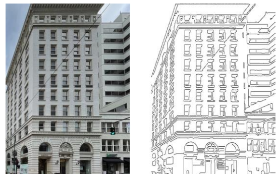
Fig. 4 ファサード写真からの線画画像生成例 Example of Image Processing
