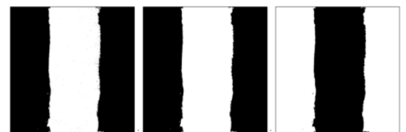
4) 二値化処理 5) ノイズの除去 6) 下地塗布領域の抽出
