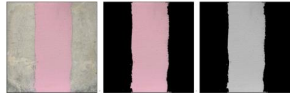
1)下地塗布領域の撮影 2) 色領域の選択 3) グレースケール変換
