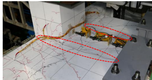
Photo 1 直交架構のみ載荷終了した時点の損傷状況 Cracks after Loading of the Orthogonal Frame
