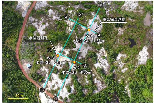
Fig. 7 電気探査および地下水位調査位置 Position of Survey using an Electrical Resistivity Survey and a Water Level Gauge
