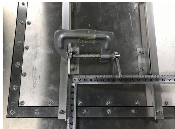
Photo 3 実験時の圧縮変形の管理方法 How to Manage Compression Deformation
