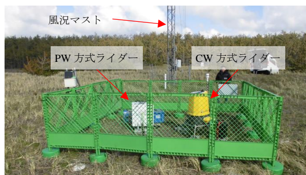
Photo 1 事前検証における計測装置設置状況 The Installed LiDARs in the In-situ Validation Site
