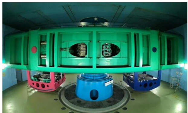
Photo 3 遠心模型実験装置 Centrifugal Model Test Machine
