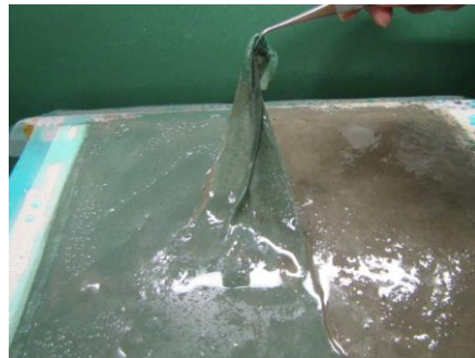
Photo 7 アルギン酸ナトリウムの散布により 生成した不溶性ゲル Insoluble Gel Produced by Spraying Sodium Alginate
