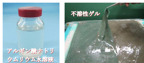
Photo 2 アルギン酸ナトリウムによる不溶性ゲルの生成 Transformation of Sodium Alginate into Insoluble Gel
