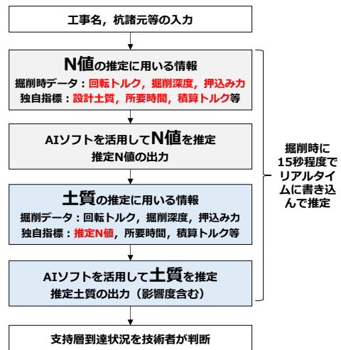
Fig. 6 N 値・土質の推定フロー Estimation Flow of N-Value and Soil
