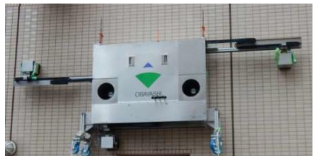
Photo 4 外壁点検ロボット Outer Wall Inspection Robot
