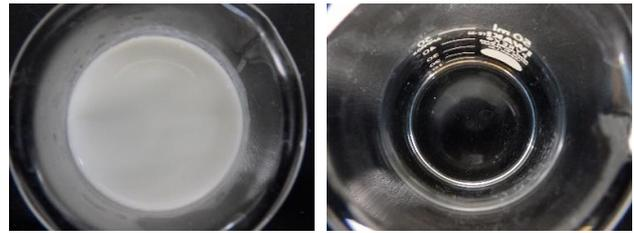
(a) CO<sub>2</sub>注入後のCa(OH)<sub>2</sub>溶液 (b) CO<sub>2</sub>注入後のNaOH溶液
