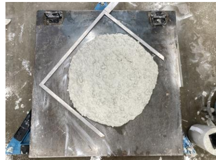
Photo 2 スランプフロー Slump Flow of Concrete
