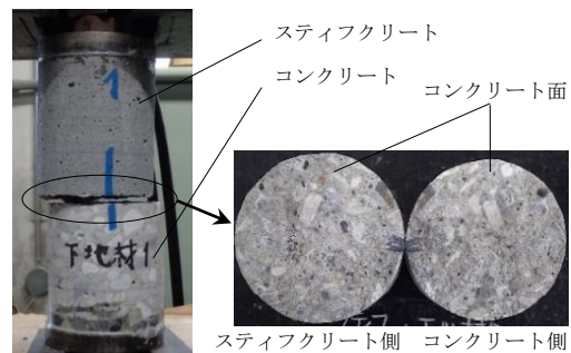
Photo 1 一軸引張試験状況および破断面 Uniaxial Tensile Test
