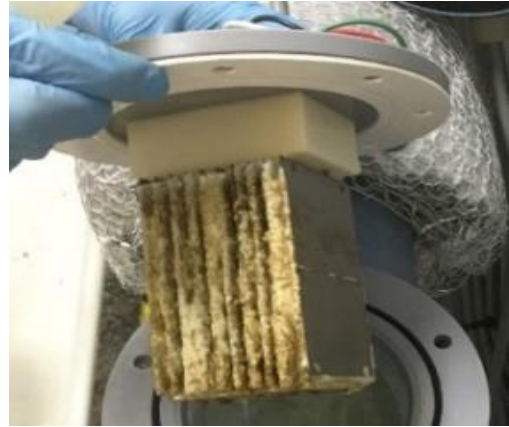
Photo 1 電解装置における塩類の析出 Precipitation of Salts in Electrolysers
