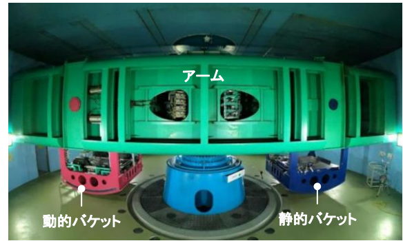
Photo 1 遠心模型実験装置全景 Centrifuge Facility
