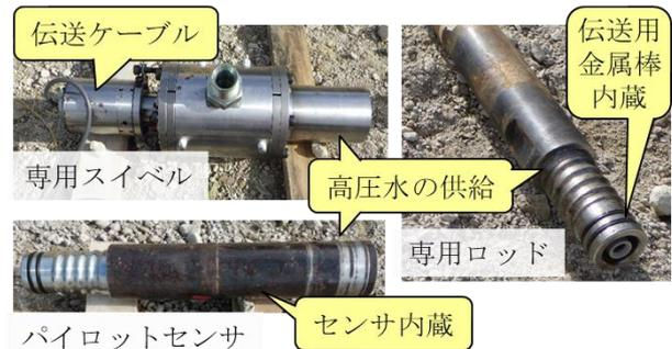
Fig. 2 削孔機械に取り付けるデータ送信装置 Devices for Acquisition of Pilot Signal
