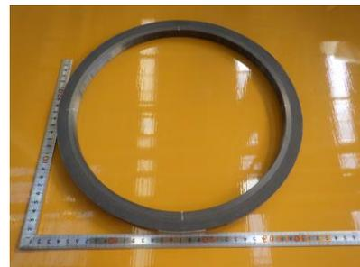
Photo 2 再生CFRPフープ筋
