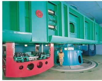
Photo 3 遠心模型実験装置
