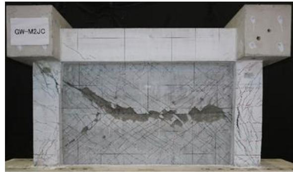
Photo 2 鉄筋モルタル造耐震補強壁の最終破壊状況
