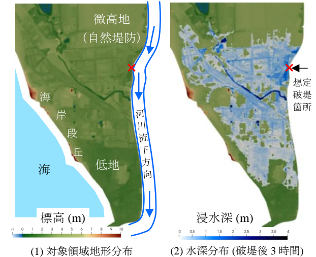
Fig. 5 ある河川の河口付近における 2 次元浸水解析の例
