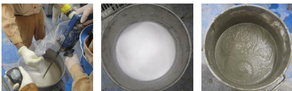
Photo 4 セメントペーストの練混ぜ状況 (左: 水と起泡剤の攪拌状況, 中央: 左の攪拌後, 右: セメントペースト練上がり状況)
