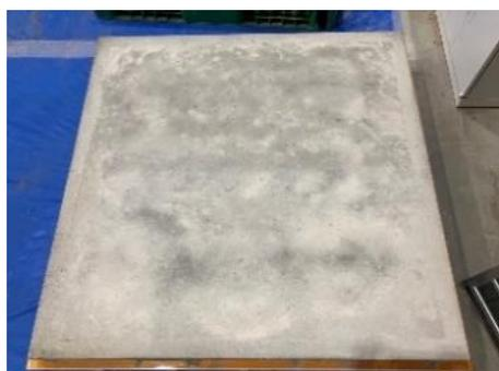
Photo 15 ポリッシャーによる除去後の試験体
