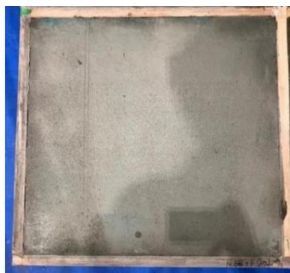
Photo 16 炭酸ナトリウムによる除去後の試験体
