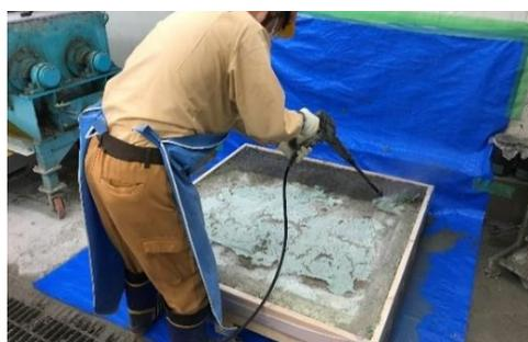
Photo 11 高圧洗浄機での除去状況
