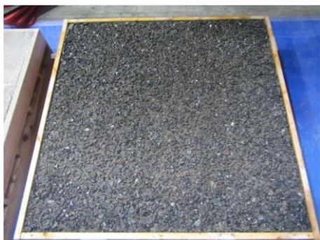
Photo 14 高圧洗浄機による除去後の試験体
