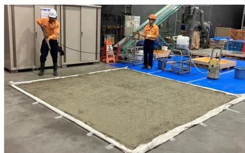
Photo 7 アルギン酸ナトリウム水溶液の散布状況
