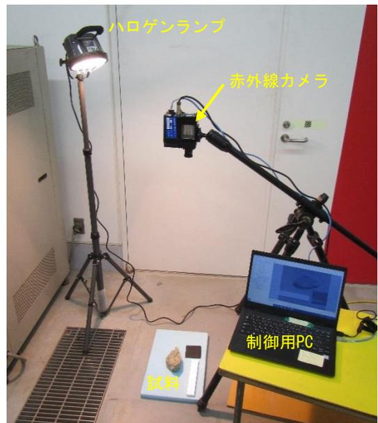
Fig. 3 赤外線カメラによる撮影状況<sup>4)</sup>
