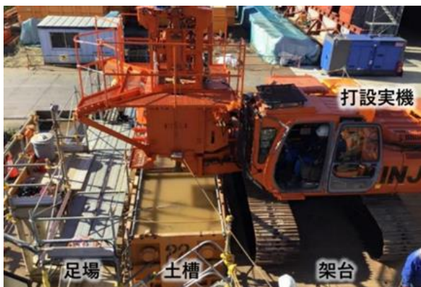
Photo 1 ドレーン材貫入実験状況 Drain Penetration Test
