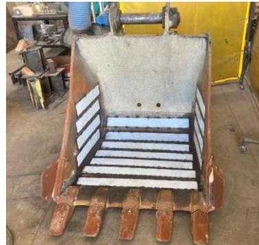
Photo 1 ジオドロップを設置したバケット
