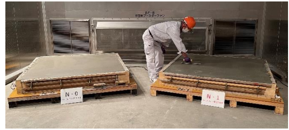
Photo 2 左官職人によるこて押え感覚の確認状況 Plaster Checks Trowel Pressure Sensation
