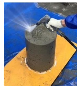
Photo 3 洗出しの状況 Exposing Aggregate
