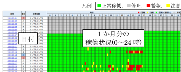
Fig. 2 振動発生概況及び死活管理 Overview of Vibration Occurrence and System Dead / Alive Status
