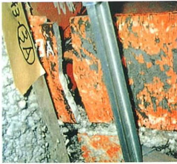
(1) スカラップ底からのき裂発生 Crack Initiated at the Toe of Weld Access Hole
