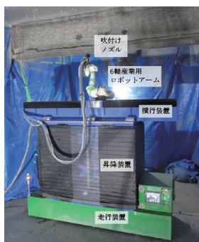
最新の建設ロボットの一例（耐火被覆吹付けロボット） An Example of the Latest Construction Robot (Fireproof Coating Spraying Robot)
