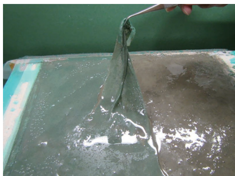
アルギン酸ナトリウムの散布により生成した不溶性ゲル Insoluble Gel Produced by Spraying Sodium Alginate
