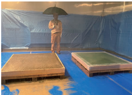
「レイニーコート™」を施工した試験体としていない試験体の比較 Comparison of Test Pieces with and without “Rainy-Coat™”
